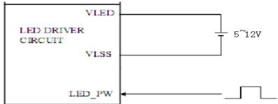
NOTE (1): ADJUST THE PWM SIGNAL IN ORDER TO CONTROL LED BACKLIGHTS
