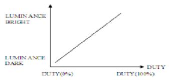
NOTE (2): PWM SIGNAL=0~3.3V · OPERATION FREQUENCY: 100+/-5 KHz
