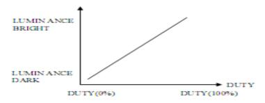
NOTE (2): PWM SIGNAL=0~3.3V · OPERATION FREQUENCY : 20±5KHz
